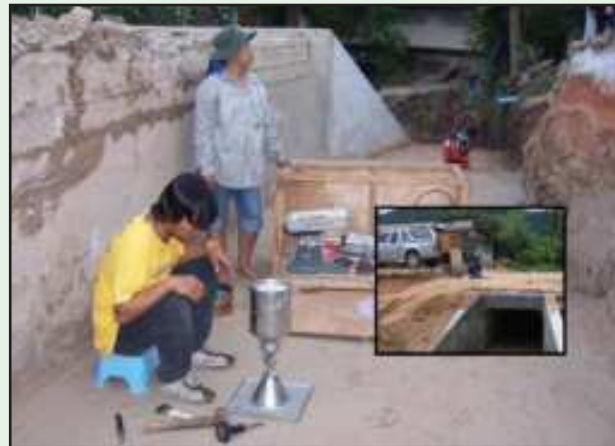
รูปที่ 5-33 รูปแสดงการทดสอบความแน่นข้างท่อเหลี่ยม
