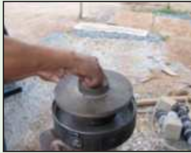
รูปที่ 3-13 แสดงการหาปริมาณยาง Asphalt Cement
