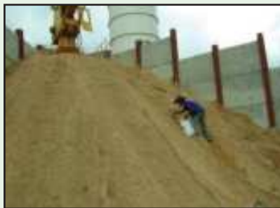
รูปที่ 5-18 การเก็บตัวอย่างวัสดุเพื่อทำการทดสอบ
