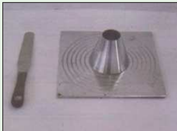
รูปที่ 3-11 การทดสอบความข้นเหลวของส่วนผสมสเลอรี่ซีล โดยวิธี Consistency Flow
