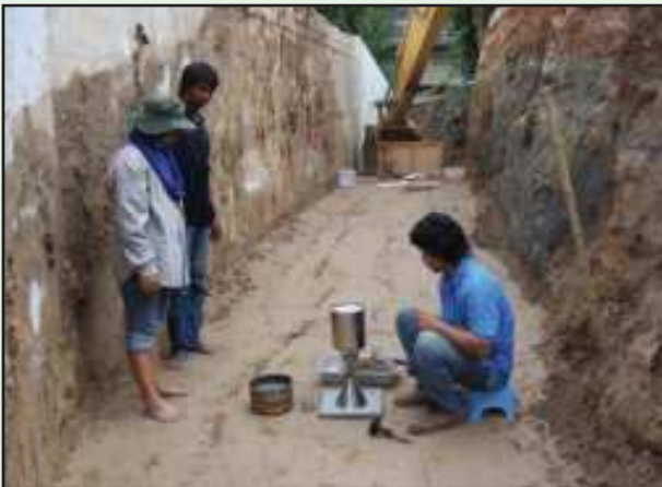
รูปที่ 5-33 รูปแสดงการทดสอบความแน่นข้างท่อเหลี่ยม
