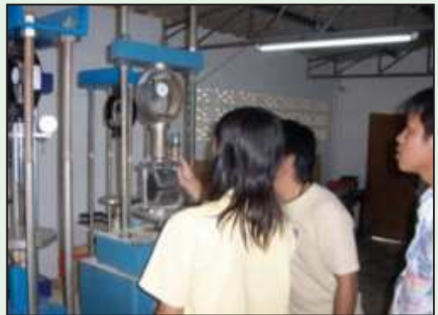
รูปที่ 3-15 แสดงการหาค่า Density Stability &amp; Flow
